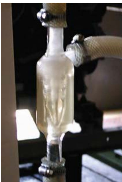
Fig. 3. Separator z pęcherzykami pary wodnej w górnej objętości Fig.3. Separator with steam bubble in top volume
